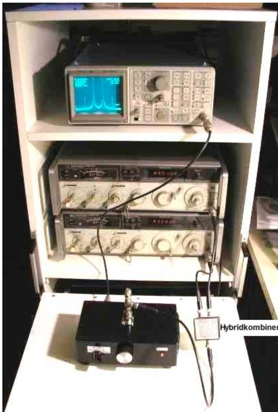
Bild 10 Messaufbau für IMD-Messung
